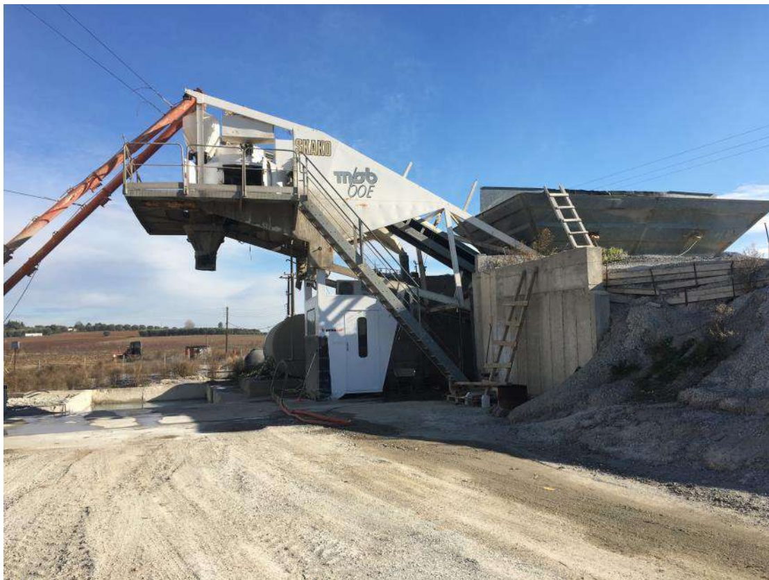
Εικόνα 6-12 Κινητή Μονάδα Παραγωγής Σκυροδέματος SKAKO
