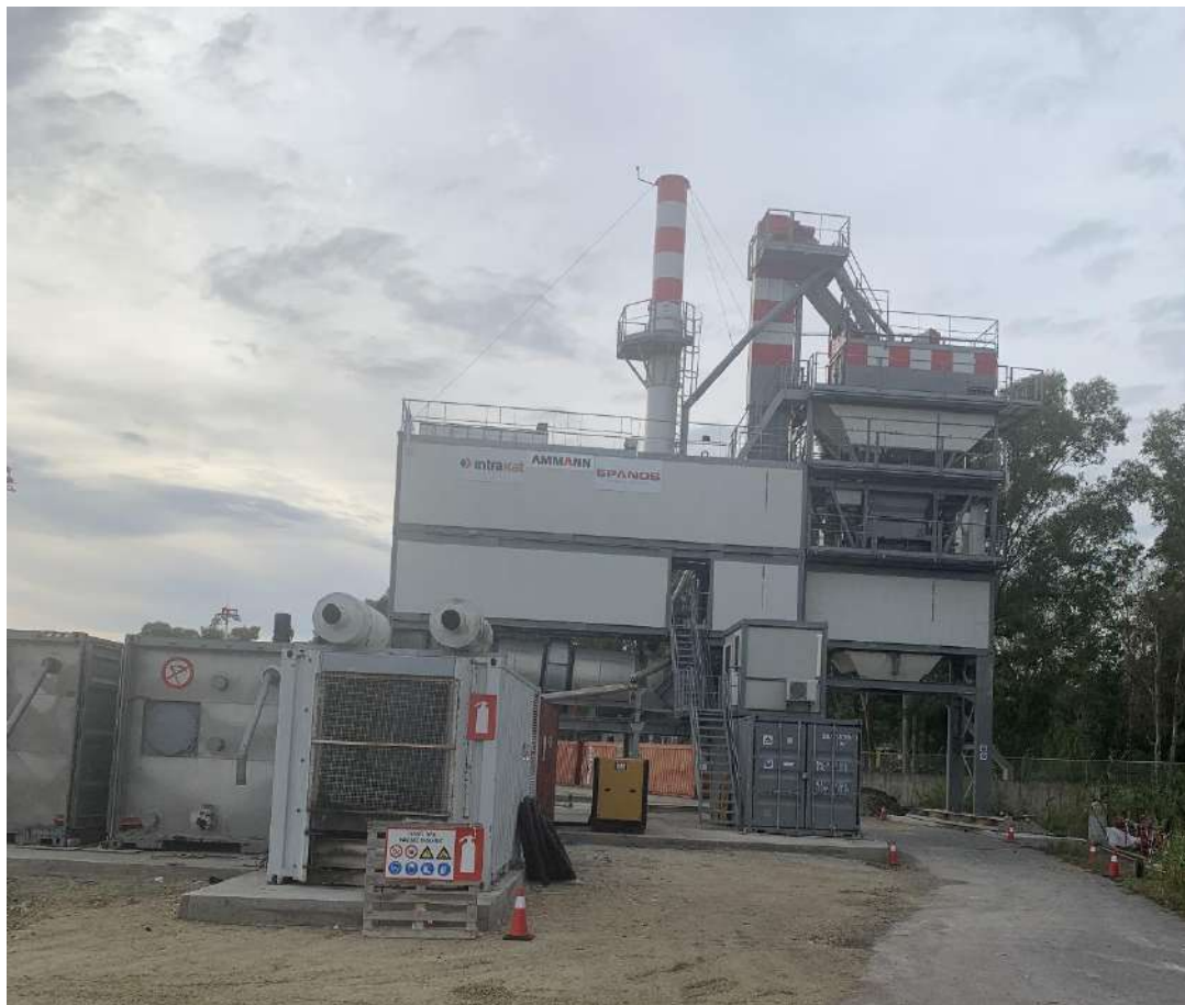
Εικόνα 6-11 Μονάδα παραγωγής ασφαλτομίγματος, Amman Group Quick Batch 180
