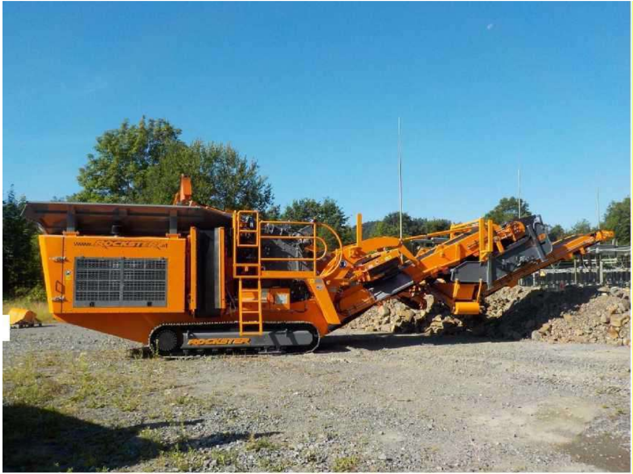
Εικόνα 14-6 Μηχανήματα επεξεργασίας ΑΕΚΚ αυτοκινούμενος σπαστήρας ROCKSTER R900
